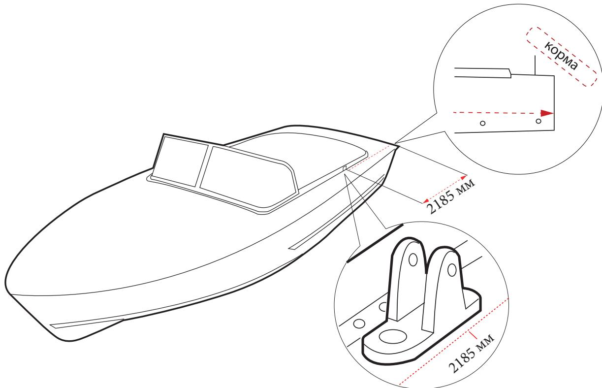
1. Установите кронштейн крепления дуг к корпусу лодки, на расстоянии 2185 мм (по центру кронштейна) от корпуса лодки со стороны кормы (см. рис). На нашем сайте, в разделе «инструкции» мы можете посмотреть фотографии размеров.
